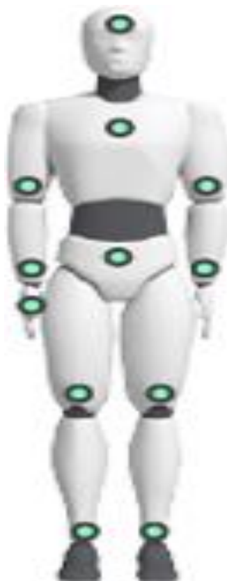
Ilustración No. 2. Localización típica de 12 sensores NOTCH.
