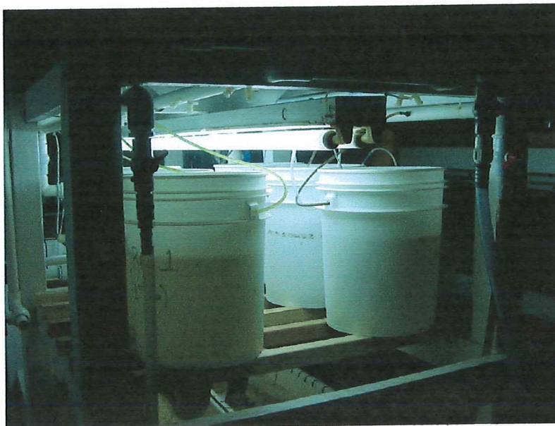
Figura 2.- Sistema de cultivo de diatomeas bentónicas utilizado para la producción de biomasa para análisis proximales.
