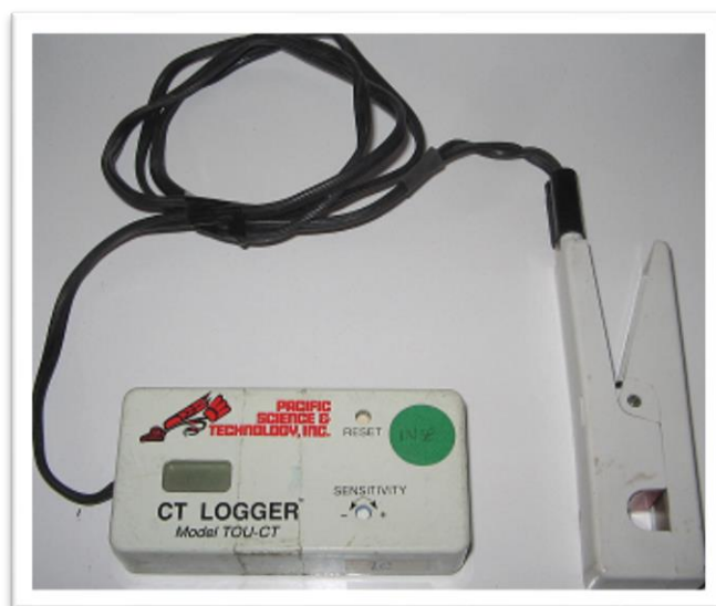
Figura 3.10: Registrador de corriente “CT Logger”.
