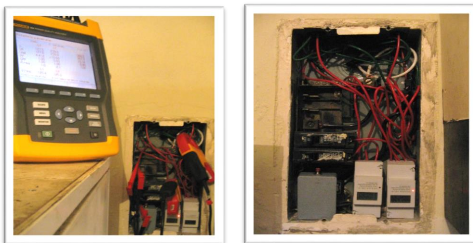
Figura 3.9: Prueba en campo de Fluke 434 y Sadpb en su configuración para circuitos.
