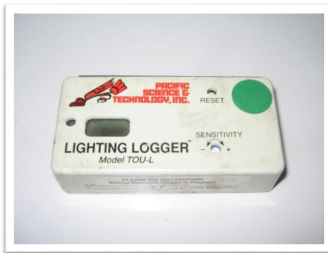
Figura 3.18: Registrador de iluminación “Lighting Logger”.
