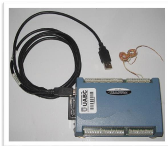
Figura 3.14: Registrador de temperaturas USB-5201.
