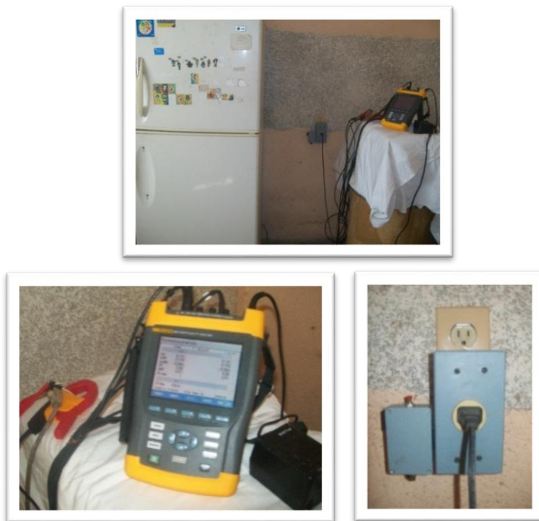
Figura 3.8: Prueba en campo de Fluke 434 y Sadpb en su configuración para cargas.
