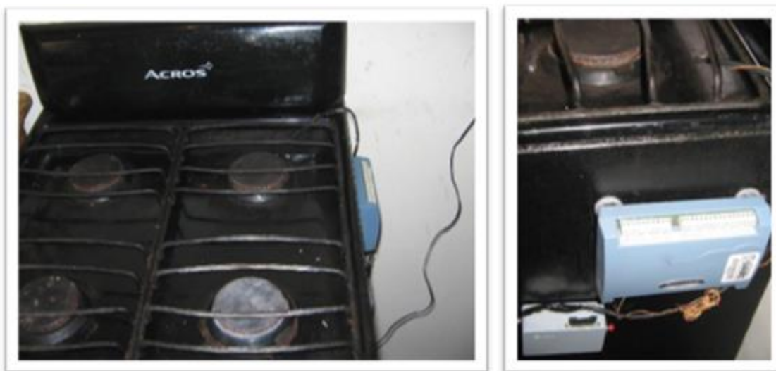
Figura 3.17: Prueba en campo de Sadgb y el registrador de temperaturas USB-5201.
