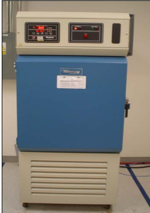
Figura 2-4. Cámara de humedad
