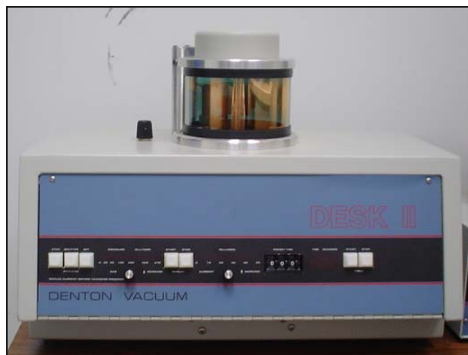
Figura 2-11. Equipo utilizado para realizar la deposición física del recubrimiento de oro
