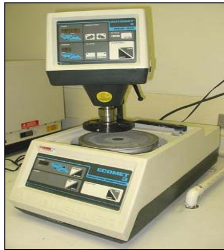
Figura 2-8. Equipo de desbaste y pulido
