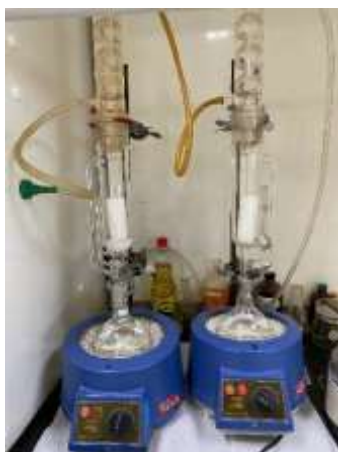
Figura 4. Extracción de grasas de las algas An y Lj por el método de Soxhlet.
