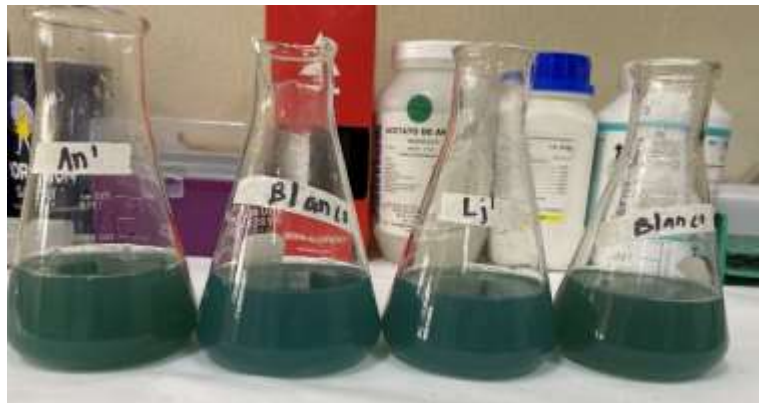
Figura 5. Determinación de carbono orgánico en extractos de algas An y Lj.
