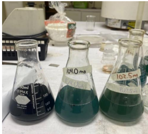
Figura 18. Determinación de carbono por método volumétrico.
