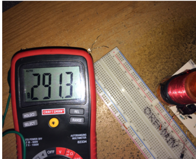
Figura 6.14. Medición del Voltaje de la bobina de Tesla sin carga
