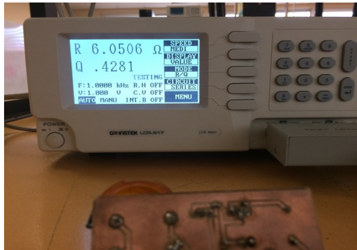
Figura 6.8. Medición de la resistencia de la bobina secundaria.
