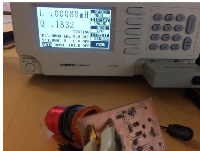
Figura 6.6. Medición de la inductancia de la bobina primaria.
