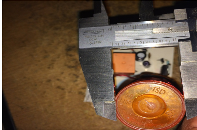
Figura 6.5. Diámetro del núcleo del embobinado.
