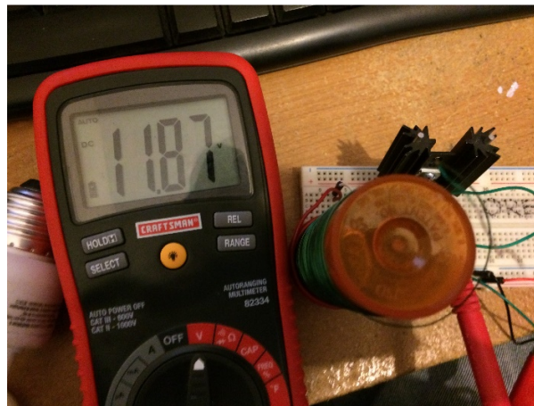
Figura. 6.12. Medición del voltaje del transistor
