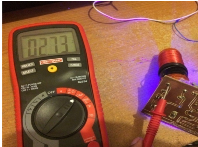
Figura 6.7. Medición de la capacitancia parasita.
