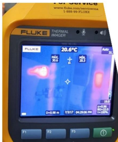
Figura 4.4 Medición de temperatura al elemento que se desea soldar, a) Imagen desenfoada, b) Imagen enfocada.
