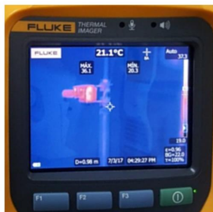
Figura 4.4 Medición de temperatura al elemento que se desea soldar, a) Imagen desenfoada, b) Imagen enfocada.
