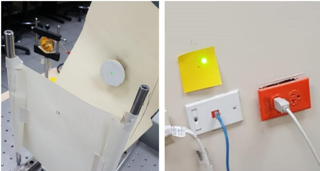
Figura 3.7 Puntos de referencia del eje óptico, a) Láser en marca dejada por la lámpara, b) Láser donde se colocará una segunda referencia del eje óptico.
