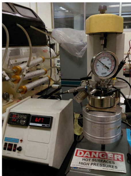
Figura 3.3. Reactor de alta presión utilizado para la descomposición térmica de los precursores tiometalatos.
