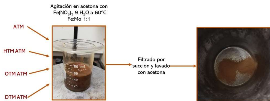
Figura 3.2. Síntesis de tiomolibdatos con hierro.
