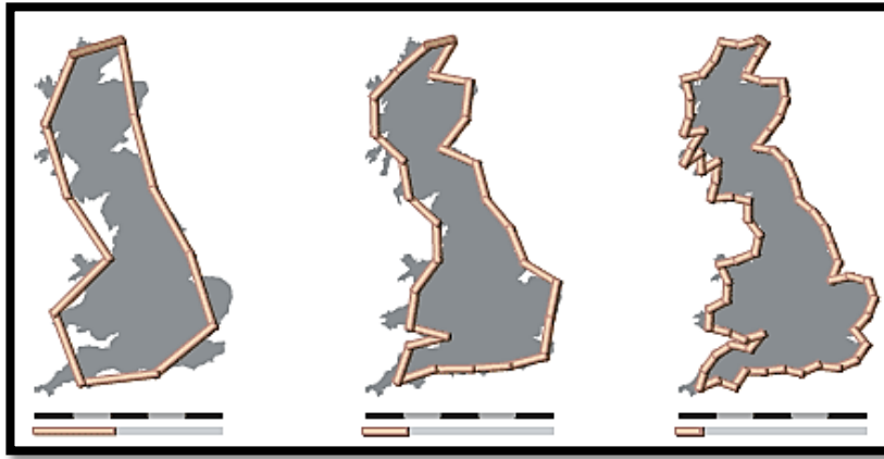
Figura 3.15.- Mediciones sobre la costa de Gran Bretaña utilizando varios valores de delta \delta . (Salbor, 1998)
