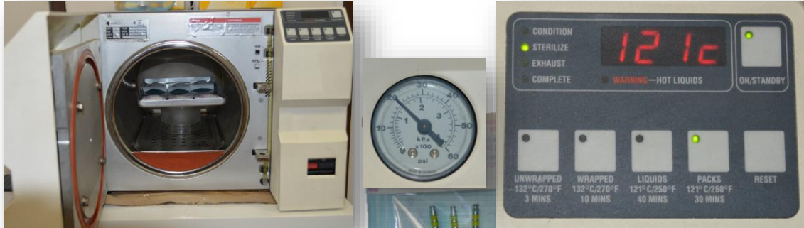
FIG 5. Esterilización en autoclave con la selección predeterminada electrónicamente, a una presión de 20 psi y una temperatura de 121°C sostenida, más 15 minutos de secado
