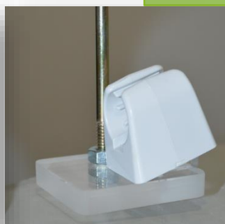
FIG 8. Base de plexiglass para el contrángulo.
