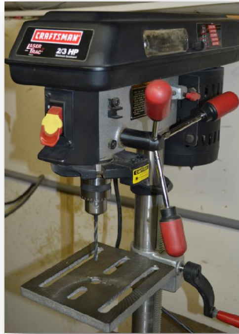
FIG 10. Taladro Industrial de banco. Las manijas laterales permiten que la cabeza del taladro descienda sobre su propio eje.
