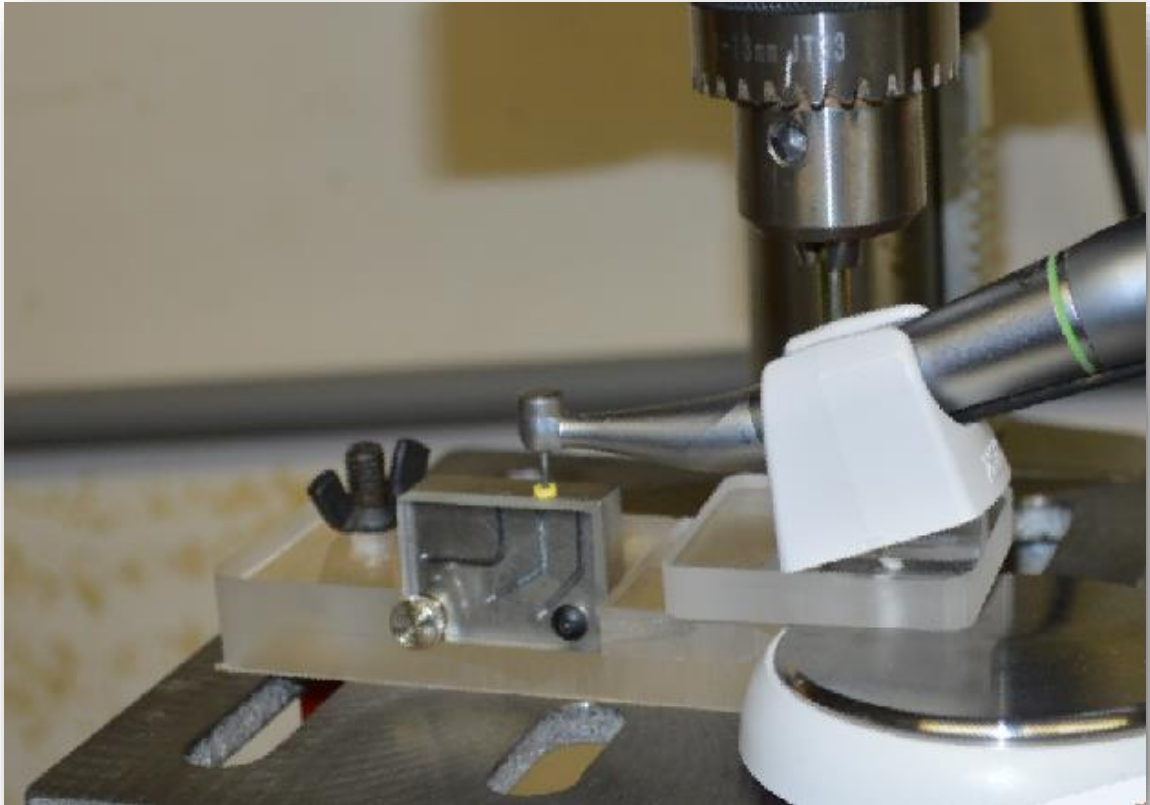
FIG 15. Inicio de la prueba de resistencia a la fatiga cíclica. Notéase como la base de plexiglass hace contacto con el pedal del motor eléctrico, activando así el contrángulo.
