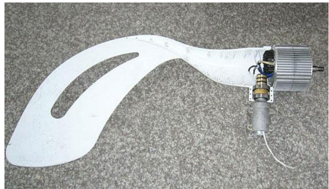
Figura 8 Distintos tipos de veleta para aerogeneradores de baja capacidad
