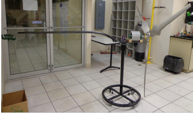
Figura 36 1er Ensamble del aerogenerador, con generador eléctrico expuesto.
