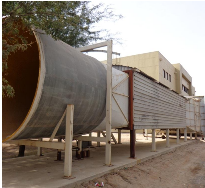
Figura 37 Vista lateral del túnel de viento rehabilitado para pruebas.
