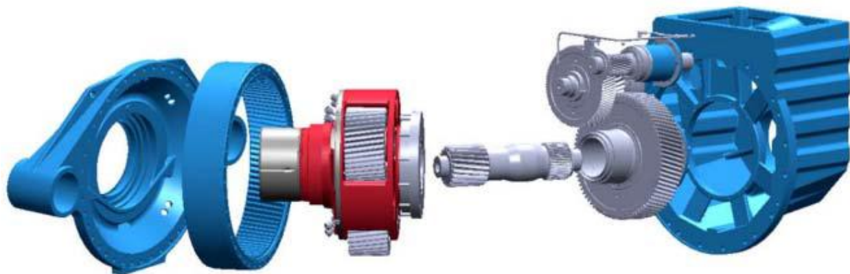
Figura 6 Caja multiplicadora con arreglo planetario
