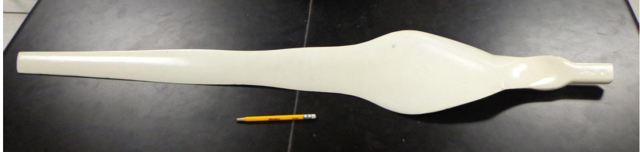
Figura 4 Alabes para aerogenerador de baja capacidad
