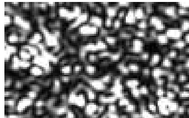
Figura 12. Patrón de speckle, imagen obtenida experimentalmente.
