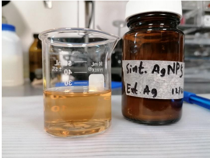
Figura 16: Apariencia de la solución de síntesis de nanopartículas de plata después de 48 horas de reacción.
