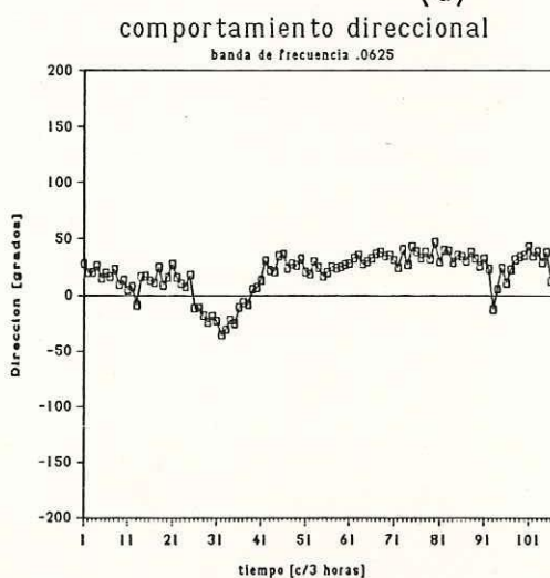
Figura 17.- Gráficas de comportamiento de la energía y comportamiento direccional por banda de frecuencia (de .0313 a .0625 Hz).
