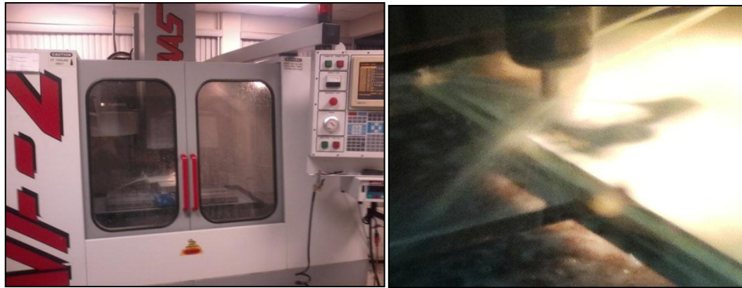
Figura 3.40. Maquinado de costilla de aluminio en CNC Haas de 3 ejes.
