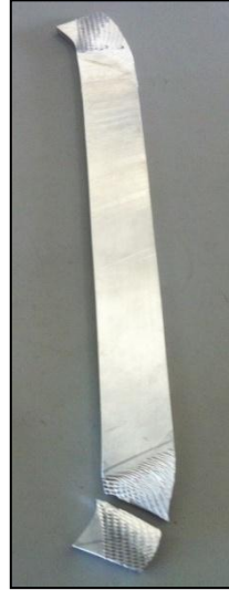
Figura 3.49 Zona de ruptura en la costilla.
