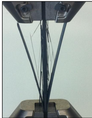
Figura 3.28 Desgarre de fibras a tensión.
