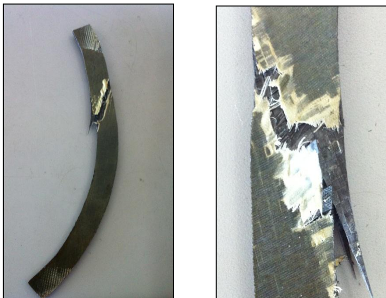
Figura 3.54 Costilla fracturada, zona de daño.
