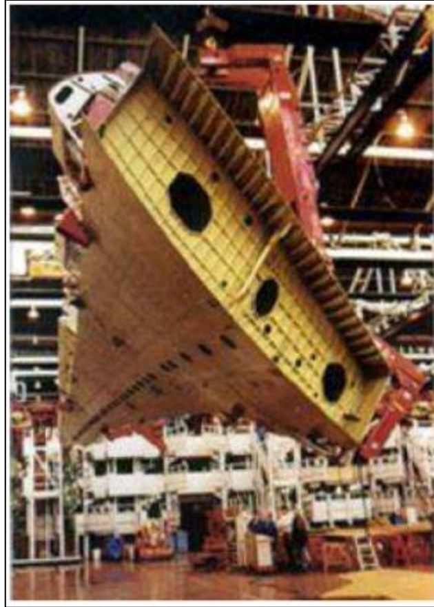
Figura 1.4 Parte interna del ala del A340 fabricada con láminas de aluminio. [4]
