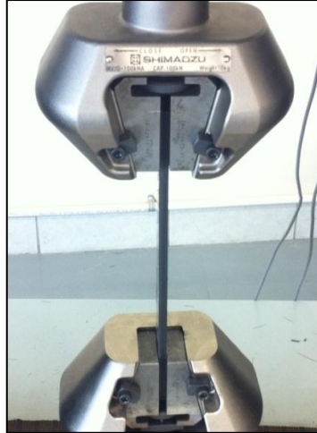
Figura 3.27 Probeta a 90° sujeta a tracción.
