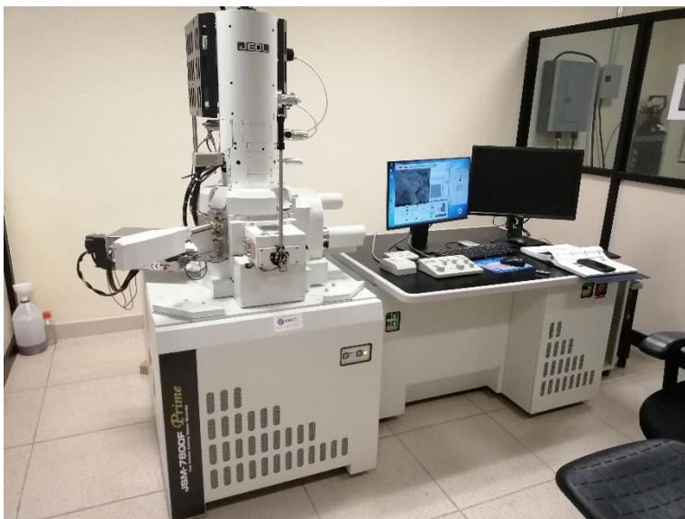
Figura 14. Microscopio Electrónico de Barrido de emisión de campo JEOL modelo JSM-7800F Prime.
