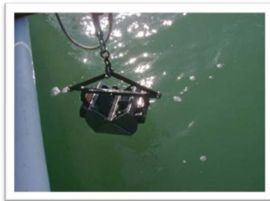
Figura 2. Lanzamiento de draga tipo Petite Ponar , de la embarcación.
