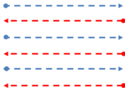
Figura 4.3.2. Patrón de barrido tipo Zig-Zag.
