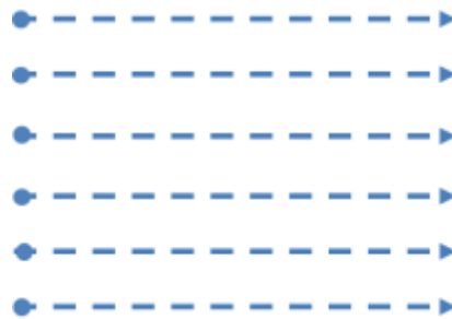
Figura 4.3.1. Patrón de barrido tipo Fly Back.
