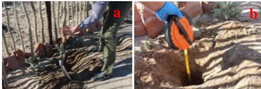
Figura 4. Realización de las perforaciones (a) y mediciones del suelo (b) a profundidades de 0-15 cm y 15-30 cm.
