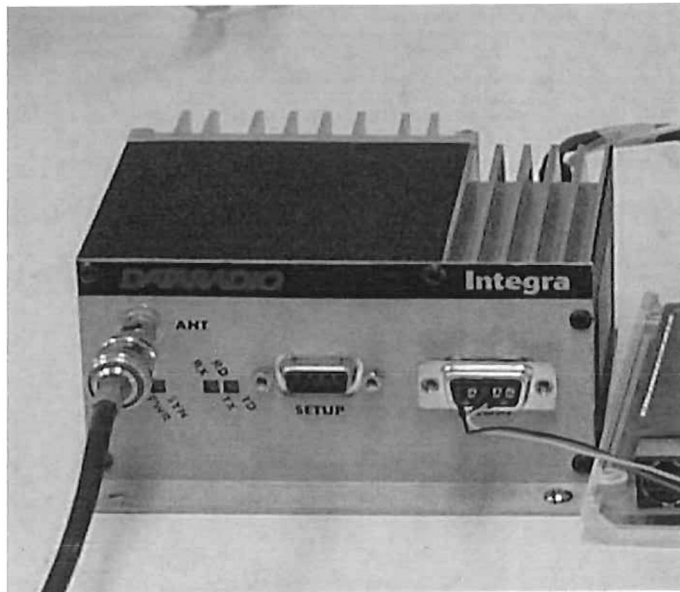
Figura 11. Radio módem Integra-TR cuenta con 2 puertos seriales (COM y SETUP) para llevar a cabo la transmisión de los datos y así como también su programación y diagnóstico de transmisión respectivamente.
