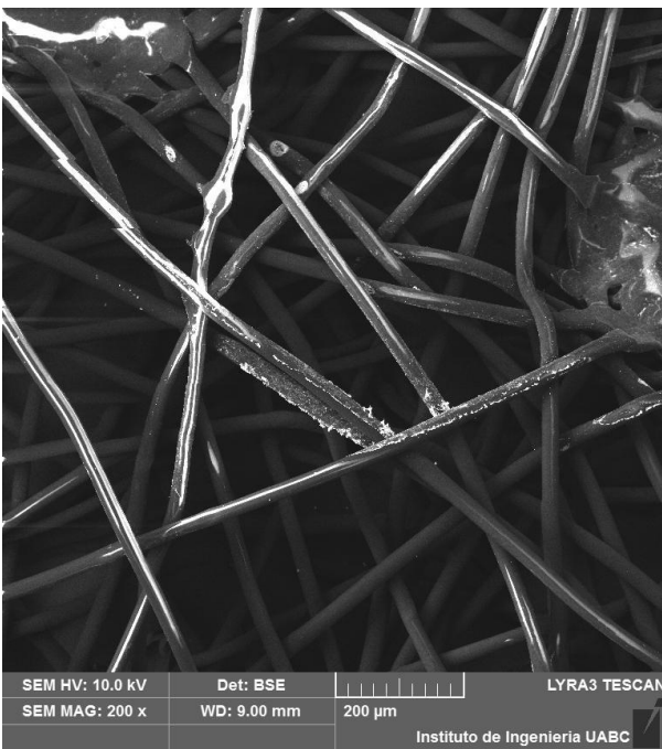
Ilustración 25 Micrografías y EDX de capa de polipropileno no tejido azul
