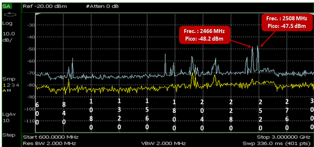
Figura 9.6 – Muestreo de 600MHz a 3 GHz para el ruido sin confinamiento blindado en test fixture. Se utilizó el equipo Keysight Technologies N9912A. La gráfica amarilla representa el promedio de potencia y la gráfica color azul cielo los picos, ambas en unidades de dBm.
