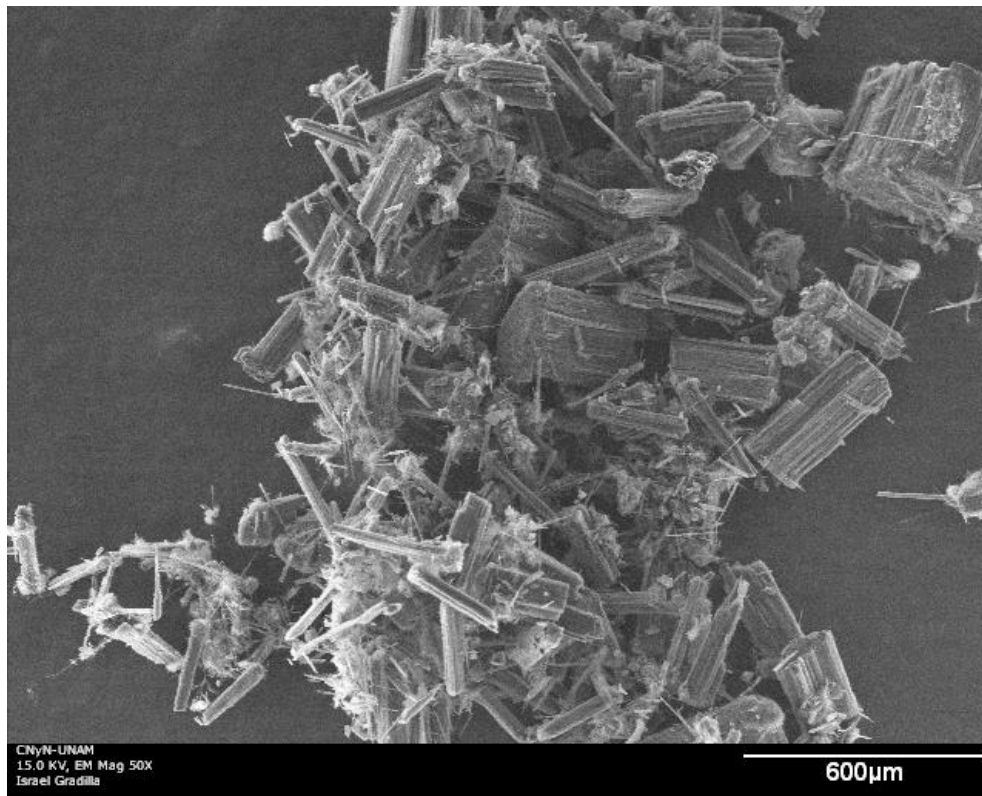
Figura 25. Vista panorámica de los CN x tomada por SEM. Se observa el crecimiento alineado en forma de tapete.
