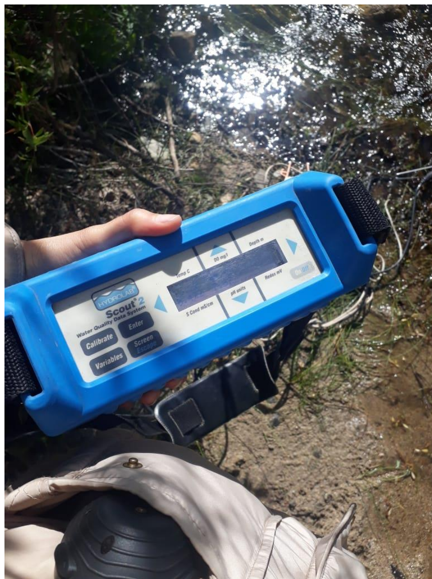
Figura 16. Equipo multianalizador Hydrolab Scout 2 utilizado en cada una de las localidades de estudio en la cuenca del río Santo Domingo, Baja California, México.
