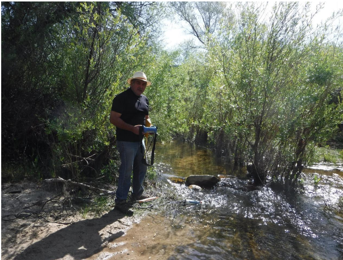
Figura 35. Medición de variables fisicoquímicas del agua con un equipo multianalizador Hydrolab Scout 2 (Hydrolab Co., Austin, Texas) en el sitio del arroyo El Potrero, perteneciente a la cuenca del río Santo Domingo, Baja California, México, 4 de mayo de 2019.
