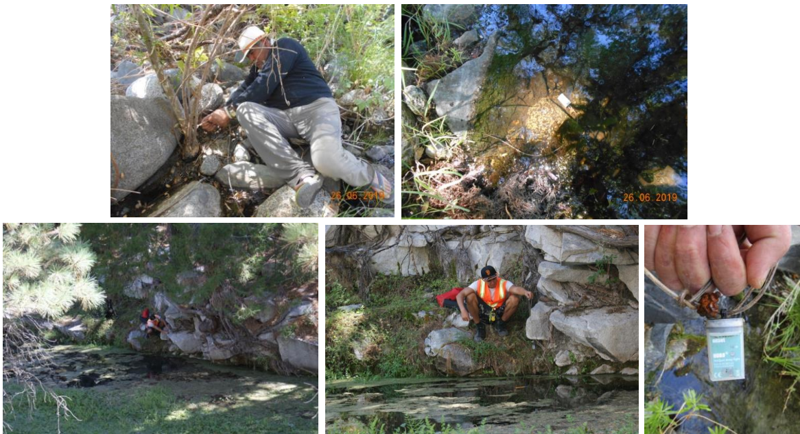
Figura 15. Colocación de los sensores de temperatura de agua HOBO en las diferentes localidades del área de estudio en la cuenca del río Santo Domingo, sierra San Pedro Mártir, Baja California, México.
