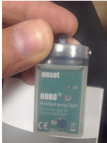
Figura 14. Termógrafo sumergible (HOBO Pendant, Modelo UA-002-08) utilizado para el registro de temperatura a intervalos de una hora, en un sitio del arroyo San Rafael, sierra San Pedro Mártir, Baja California, México.
