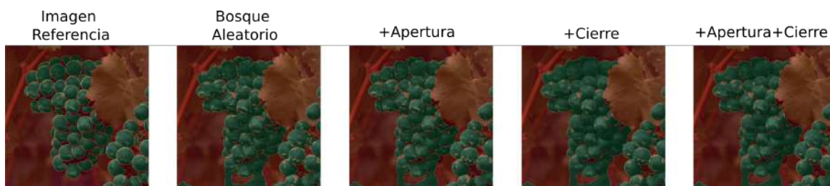
Figura 4.16: Operadores de morfología sobre CosmeDS. Imagen de entrada con el resultado de cada operador sobre puesto; clases fondo y uva corresponden a los colores rojo y verde, respectivamente.
