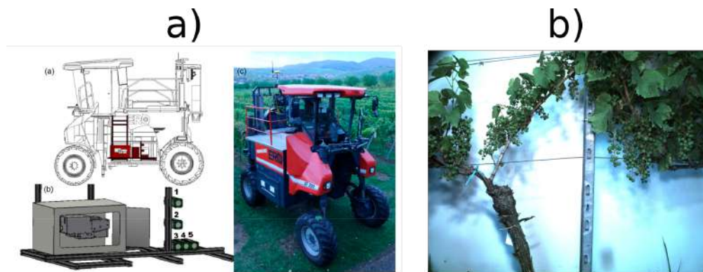
Figura 2.6: La plataforma PHENOliner. Propuesta de Kicherer et al.[46]: (a) imagen del montaje real, (b) imagen muestra tomada de [47].
