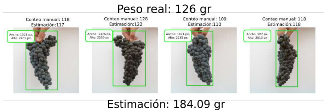
Figura 4.38: Predicción del peso sobre la variedad Cabernet Sauvignon . Se muestran cuatro capturas sobre el mismo racimo, en donde se incluye el conteo manual y el conteo de frutos estimado; también el peso real y el peso estimado por el modelo de regresión lineal. Por otro lado, se incluyó un rectángulo verde con las medidas en píxeles de alto y ancho.
