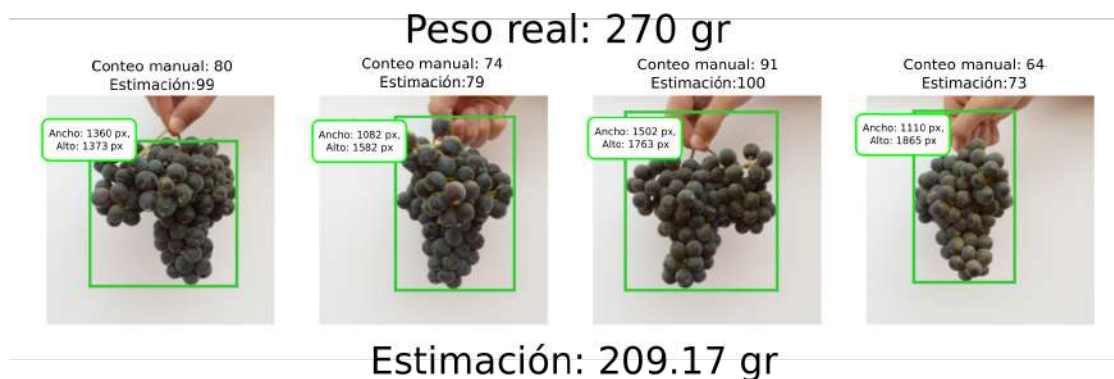
Figura 4.39: Predicción del peso sobre la variedad Cabernet Franc . Se muestran cuatro capturas sobre el mismo racimo, en donde se incluye el conteo manual y el conteo de frutos estimado; también el peso real y el peso estimado por el modelo de regresión lineal. Por otro lado, se incluyó un rectángulo verde con las medidas en píxeles de alto y ancho.
