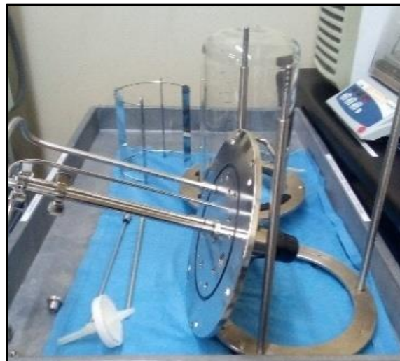
Figura 25. Correcta colocación de soporte de la tapa del biorreactor.
