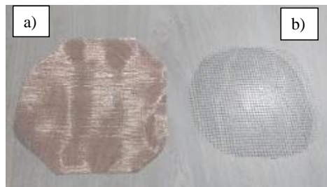
Figura 31. Electrodo; a) Cobre y b) Zinc
