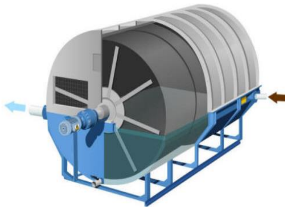
Figura 9. Esquema de biodisco [33]
