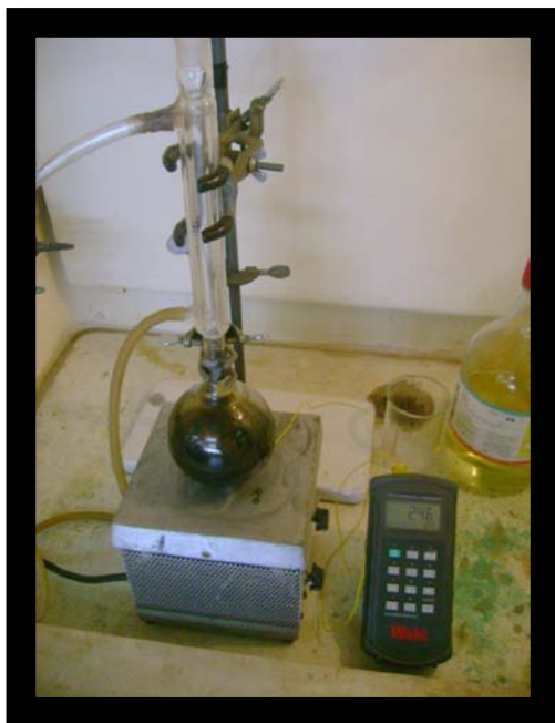
Figura 4.2 Arreglo de Sistema para Reflujo de \text{HNO}_3
