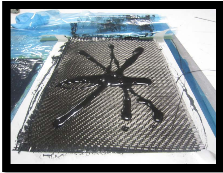
Figura 4.5.2 Wet layup del laminado de fibra de carbono y resina con nanofibras
