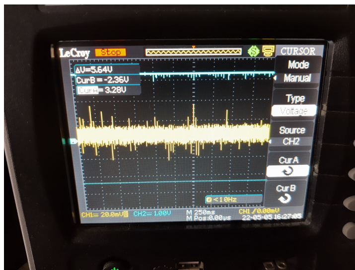
Figura 4.7: Señal saturada. Medición hecha en osciloscopio.
