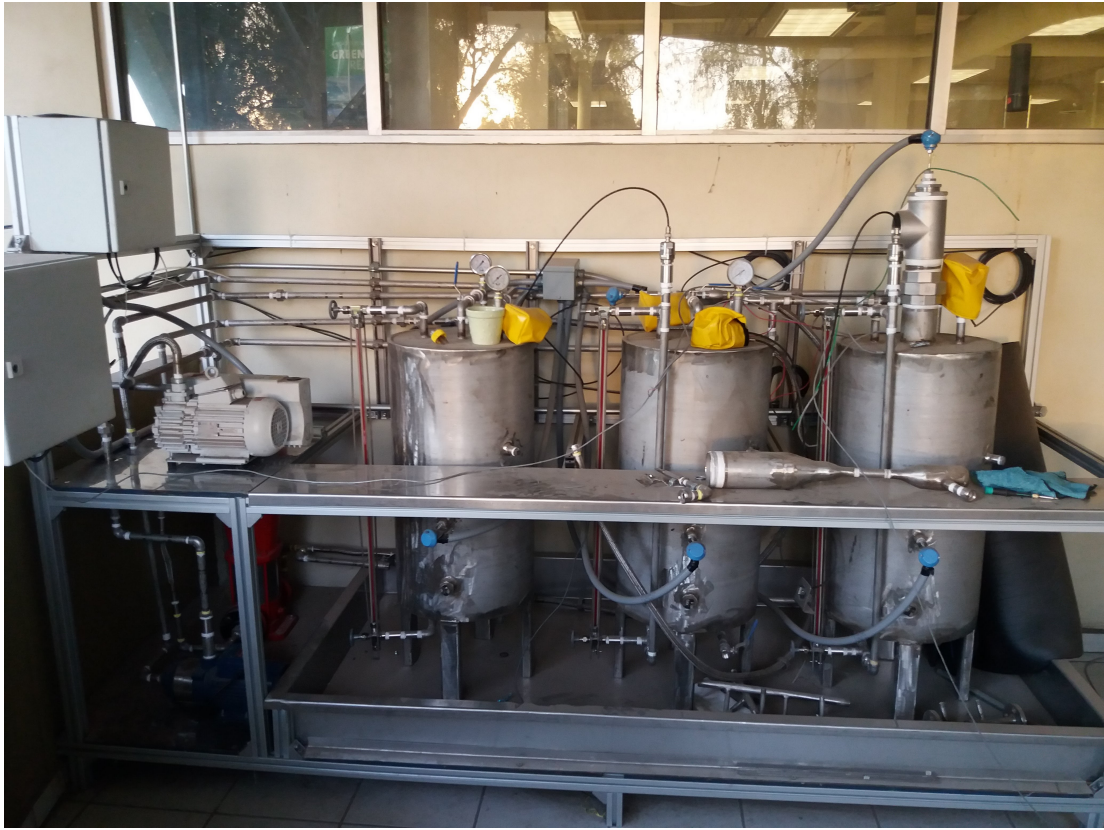
Figura 4.26: Banco de pruebas de eyectores construido y conectado eléctricamente.
