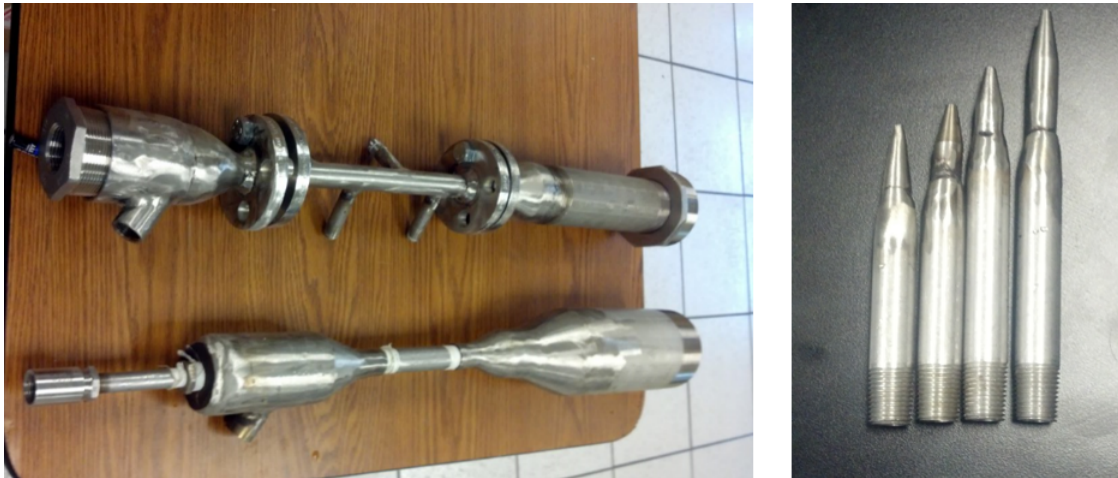
Figura 4.25: Construcción de los prototipos de eyectores.
