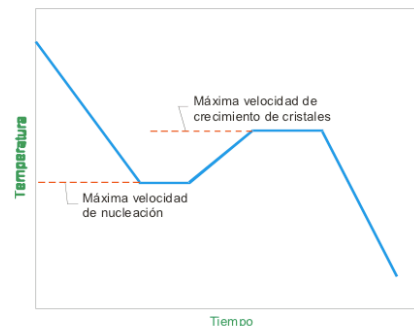
Esquema del programa térmico para la obtención de materiales Vitro cristalinos
