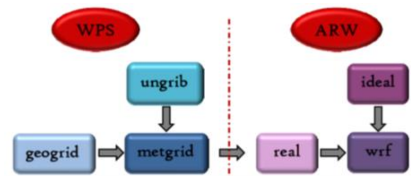
Figura 8. Esquema de los módulos WPS y WRF. Fuente: Skamarock et al. (2008).
