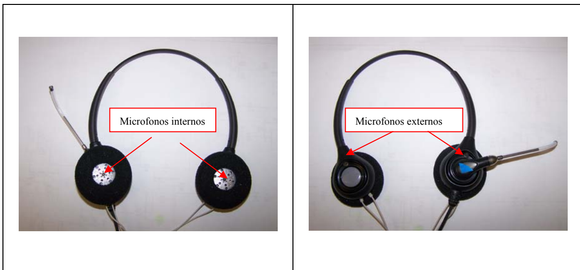
Figura 3-1. Arreglo de micrófonos supervisores en la diadema de comunicaciones prototipo
