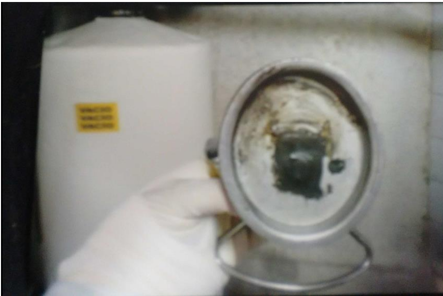
Foto.2. Tapa del deposito donde se almacena el agua que alimenta las Unidades Dentales.
