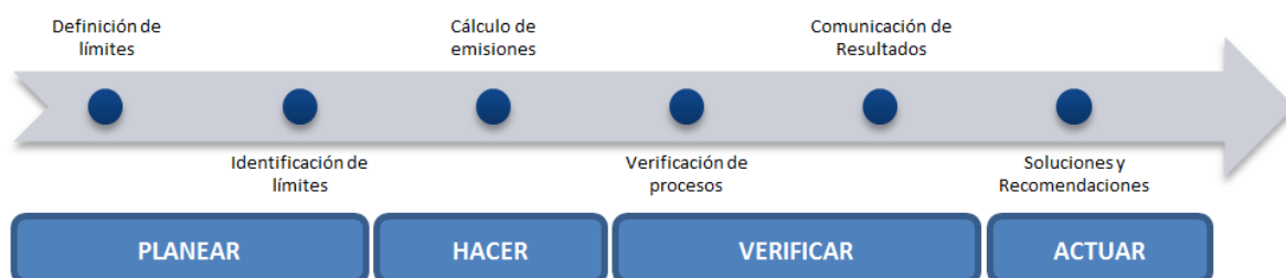
Figura 4.1. Diseño final de la metodología utilizada para el cálculo de la Huella de Carbono de la FIN Tecate. Fuente: Elaboración Propia.
