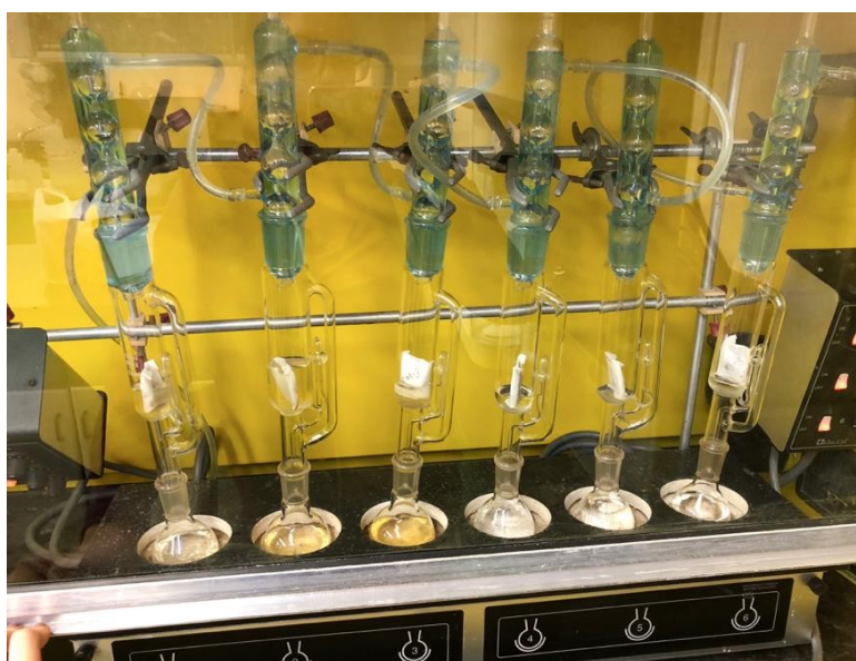
Figura 7. Extracción de lípidos con el método de Soxhlet.
