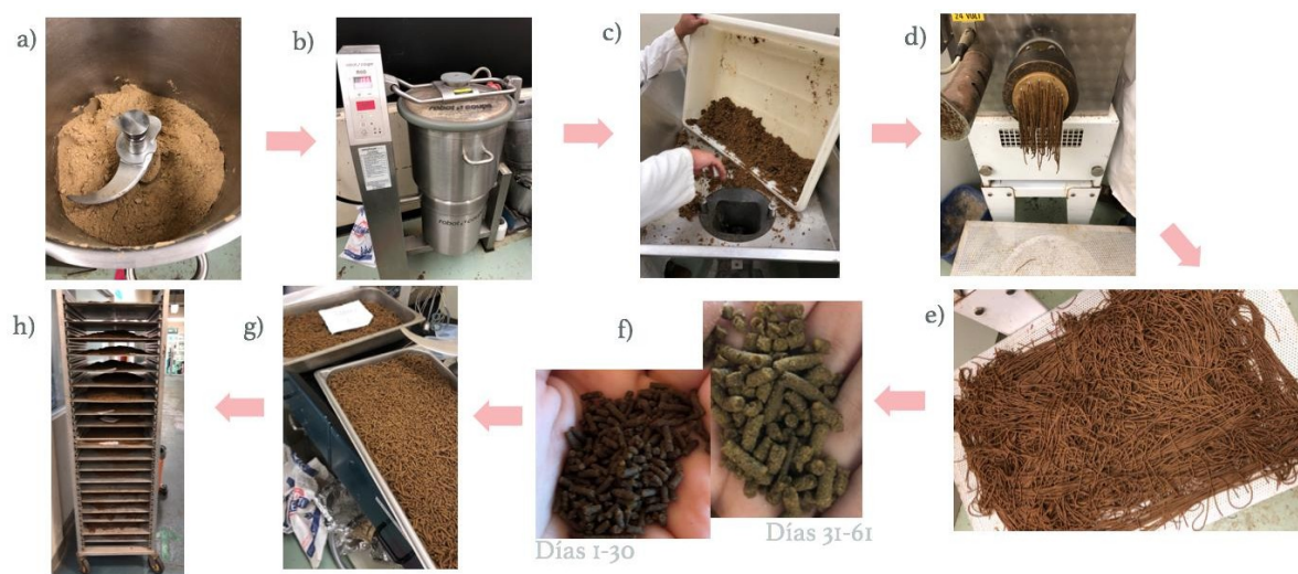
Figura 3. Proceso de preparación de las dietas experimentales, a) y b) mezcla de los ingredientes, c) y d) pelatizado de la mezcla, e) enfriamiento de la mezcla, f) corte de alimento, g) etiquetado y h) secado a 60 °C por 24 horas.
