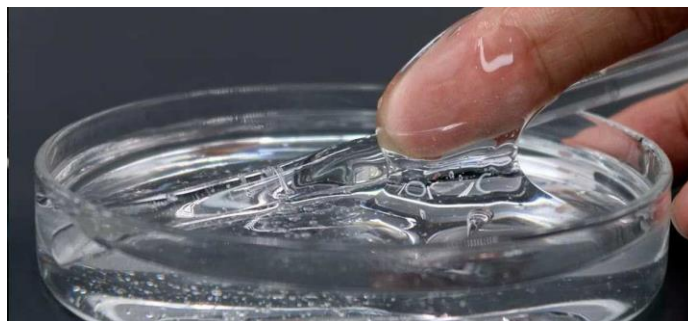
Figura 2.4. Imagen de PDMS antes de su reticulación.
