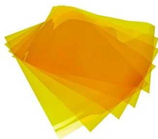
Figura 2.5. Imagen de poliimida Kapton HN.
