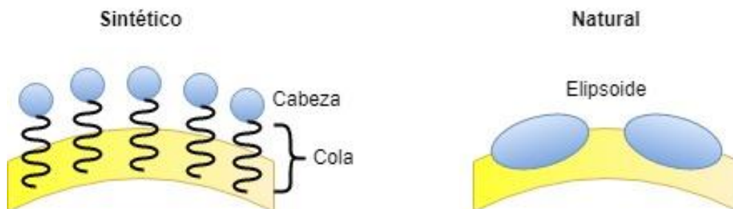
Figura 3. Estructura de emulsificantes de molécula pequeña.
