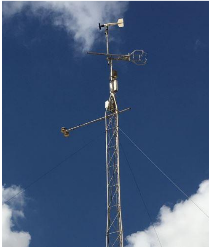
Figura 3.4. Anemómetro sónico a 20 metros de altura. Instituto de Ingeniería, UABC. Mexicali, Baja California, México.
