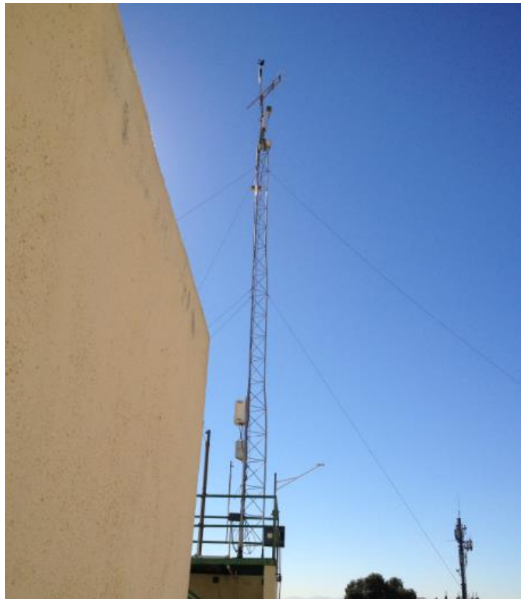
Figura 3.2. Estación meteorológica en azotea de Instituto de Ingeniería, UABC. Mexicali, Baja California, México.
