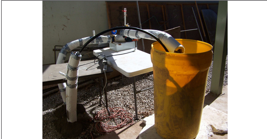
Figura 07.- Test de respuesta térmica. Equipos de medida.
