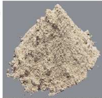
Figura 2.b.- Bentonita Sódica para uso en ingeniería civil.
