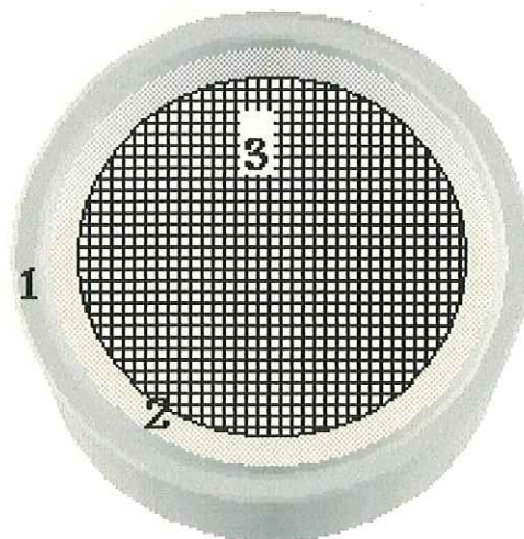
Figura 2. Esquema de los tamices utilizados para separar los ovocitos de Paralichthys californicus en diferentes intervalos de diámetro. 1, cople de PVC de 8.89 cm (3.5"); 2, tubo de PVC de 7.62 cm (3"); 3, malla para separar los ovocitos (132 \mu\text{m} - 761 \mu\text{m} ).
