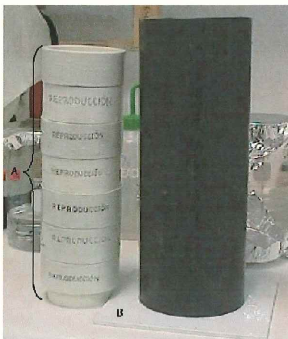
Figura 3. A. Tamices ensamblados verticalmente de mayor (parte superior) a menor apertura de malla (parte inferior). B. Tubo en el que se introdujo la columna de tamices para realizar la separación.
