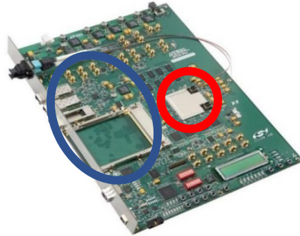
Figura 2.13. Tablero de prueba que contiene un BGA con conectores integrados MicroPOD 12 marcados en la figura de color rojo, mientras que en color azul están marcadas las conexiones ópticas y eléctricas previas a la tecnología óptico-electrónicas [].
