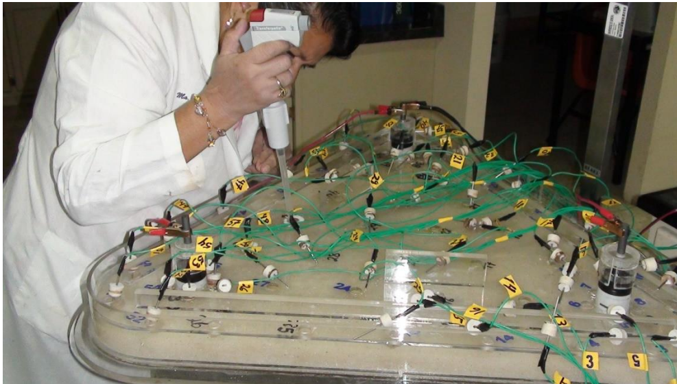
Figura 17. Recolección de muestras de solución acuosa en la celda experimental.
