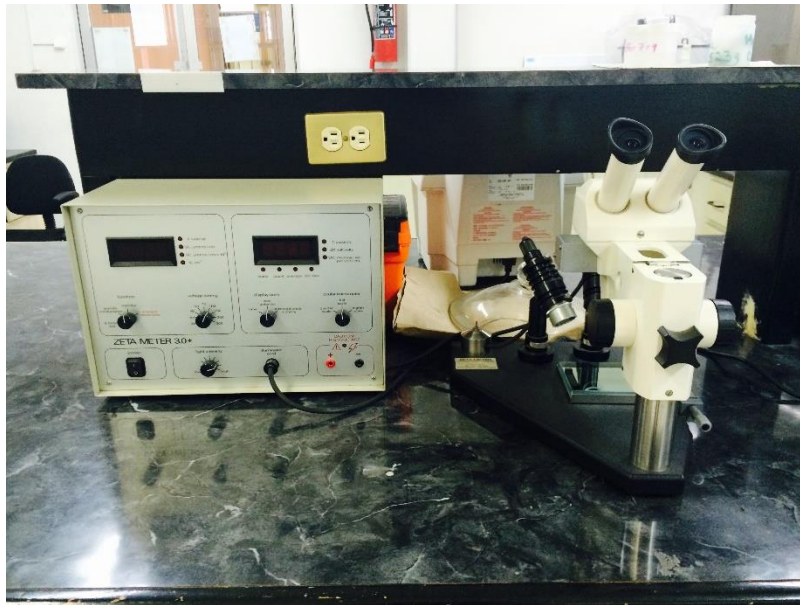
Figura 14. Equipo de medición de potencial zeta utilizado con una muestra de sílica gel.
