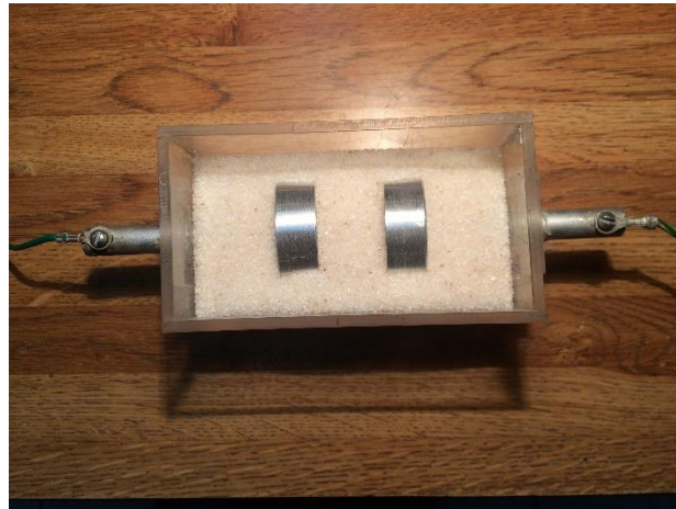
Figura 12. Celda experimental para la medición de la conductividad eléctrica de la sílica gel.
