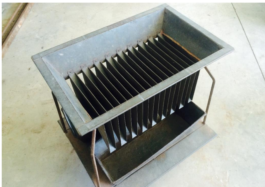
Figura 18. Cuarteador utilizado para homogenizar las muestras de sílica gel.
