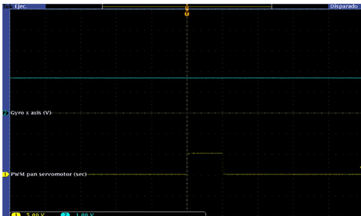
Figura 15. La línea superior color azul indica el nivel de voltaje de la salida x del giroscopio (1.0V), en la parte inferior se mide la señal pwm (1.0ms) para enviar al servomotor y ejecutar un movimiento angular de 13^\circ . (Fuente: Propia del autor).
