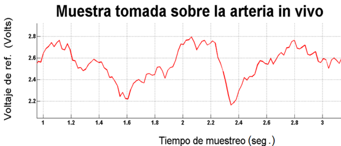
Figura 45. Lectura de sensor óptico reflexivo incidiendo directamente sobre el tejido de la túnica adventicia de la arterial. (Fuente: Propia del autor).
