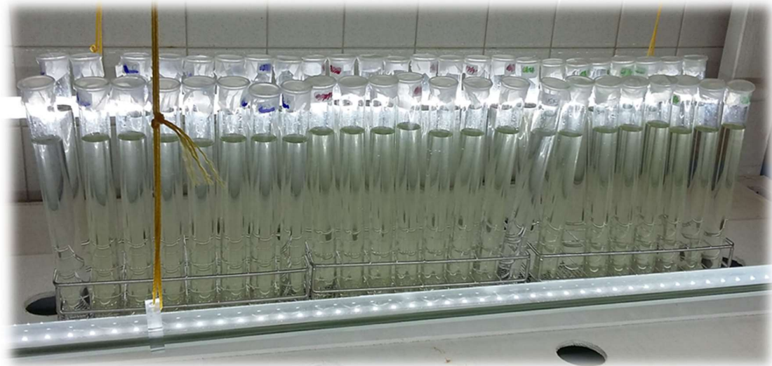
Fotografía 5. Cultivos estáticos sin aireación de D. tertiolecta en tubos de ensayo (80 mL) para la exposición a la WSF (inciso 5.2).
