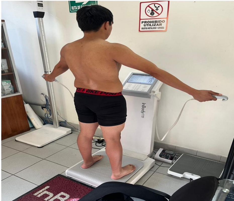
Figura 2. Ejemplificación de composición corporal por bioimpedancia (prueba InBody) realizada en los sujetos de estudio.
