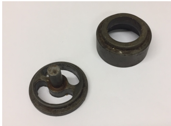
Figura 5. Inserto diseñado para la extrusión de alimento para Atún
