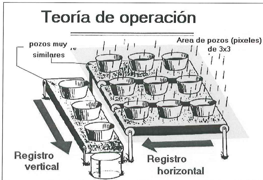
Figura 20. Teoría de operación de los CCD's.
